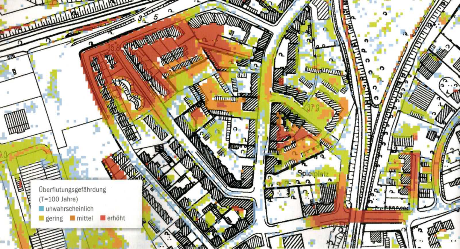
Überflutungsanalyse: Die Anpassung des urbanen Raums an Extremniederschläge kann künftig nicht mehr einzig mit den konventionellen Methoden der Siedlungsentwässerung gelöst werden.
